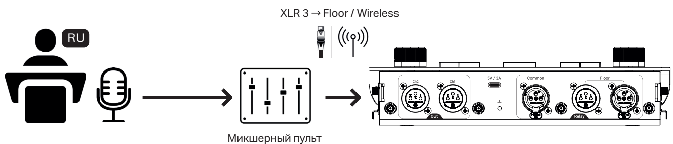
Подключение пульта синхронного перевода к микшерному пульту
